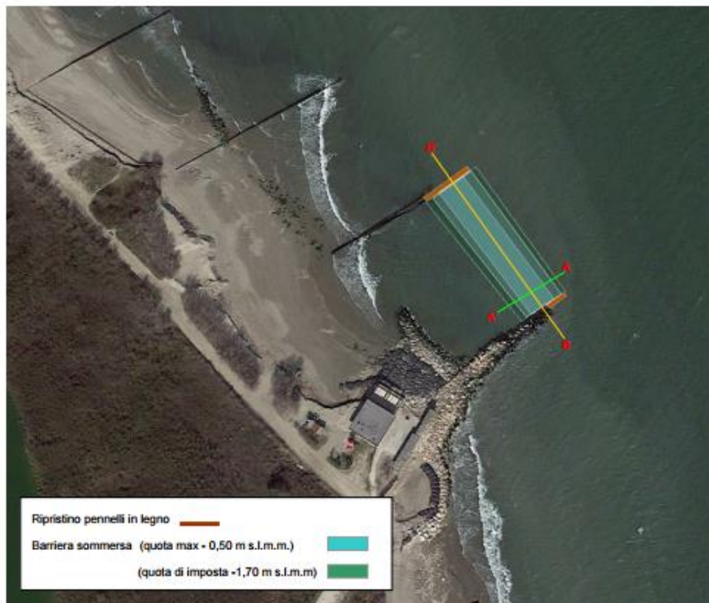
Figura 2 - Esempio di lavori di manutenzione delle opere di difesa: ripristino dei pennelli di legno e delle barriere sommerse.
