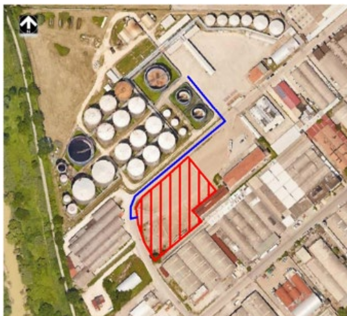
Figura 8: L'area individuata per il deposito temporaneo di rifiuti (in rosso) ed il percorso dei mezzi per il trasporto dei rifiuti dall'impianto al deposito temporaneo (in blu)
